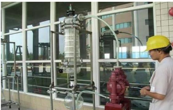
测试塔陶瓷填料 (测试的 10 个样品中有 8 个未能达到耐腐蚀要求)
