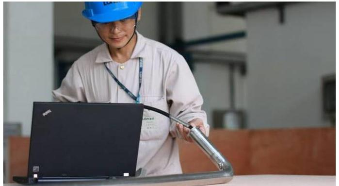
检查并记录焊缝的质量状况（电子内窥镜）
